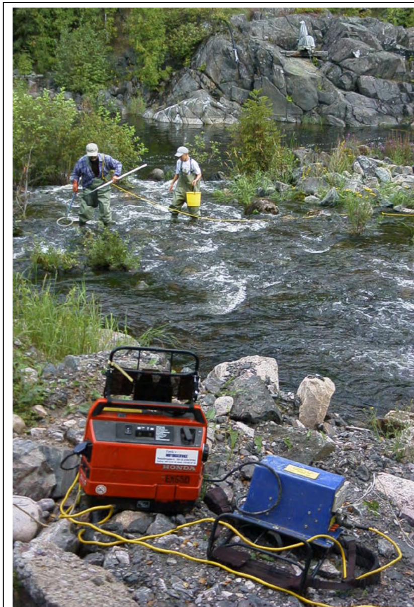
Figur 2. I bakgrunden elfiskar Arnøholander med Andreaslohlander som medhjälpare. I förgrunden till vänster elverket som genererar upp till 1 000 Watt. Till höger i förgrunden själva "elfiskelådan" som i princip är en likriktare som ger likström med en utgående spänning som kan ställas in från 300 till 1000 Volt. Notera den gula kabeln som är ca 50 m och går i en vid båge ned till Arnes elfiskestav.
